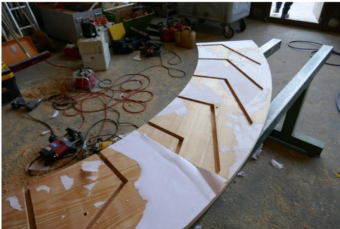
Wasserrad mit Nuten für Schaufeln
