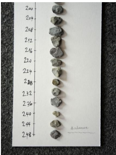
Gesteinsproben alle 4 Meter
